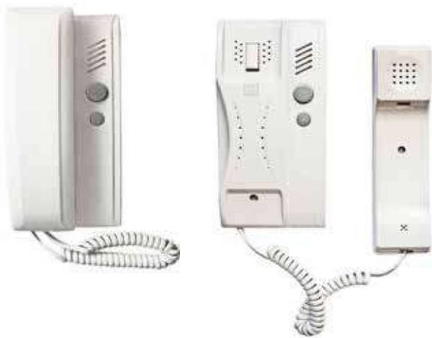
**Трубка координатная J2000-7** для работы с подъездным домофоном координатного типа Vizit, Метаком, Элтис, Цифрал и аналогичным. Настройка уровня громкости сигнала вызова, световой индикатор вызова, кнопка управления замком и вызова консьержа. Габариты 196x85x50мм, 220гр.
