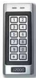
Имеет вход/выход wiegand 26-37. Питание 12В. Потребление 80mA. Память контроллера 1000 пользователей. Встроенный считыватель карт Em-Marine. Длина PIN-кода 4-6 цифр. Защита IP66. Встроенное реле макс. нагрузка 2А. Температурный режим от -40 до +60. Металлический корпус. Возможность работы в режиме «Шлюз». Может работать как считыватель. Подсветка клавиатуры. Габаритные размеры: 122x50x21мм.
