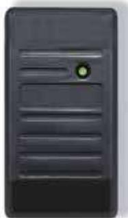
Стандарт карт: Em-Marine. Дальность считывания 3-6 см. Выходной интерфейс Wiegand 26\34. Питание 12 вольт. Потребление 80mA. Габаритные размеры 80x40x13мм. Температурный диапазон от -20 до +70. Защита IP 65
