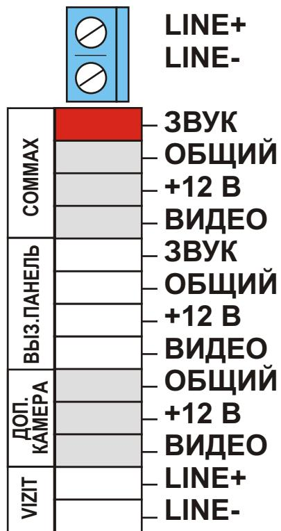
Рис.1 Цоколевка соединительного шлефа
