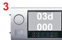
Зажать кнопку “ПЕРЕКЛЮЧЕНИЕ ВИДЕОКАМЕР” на 12 секунд, до появления надписи на экране.
